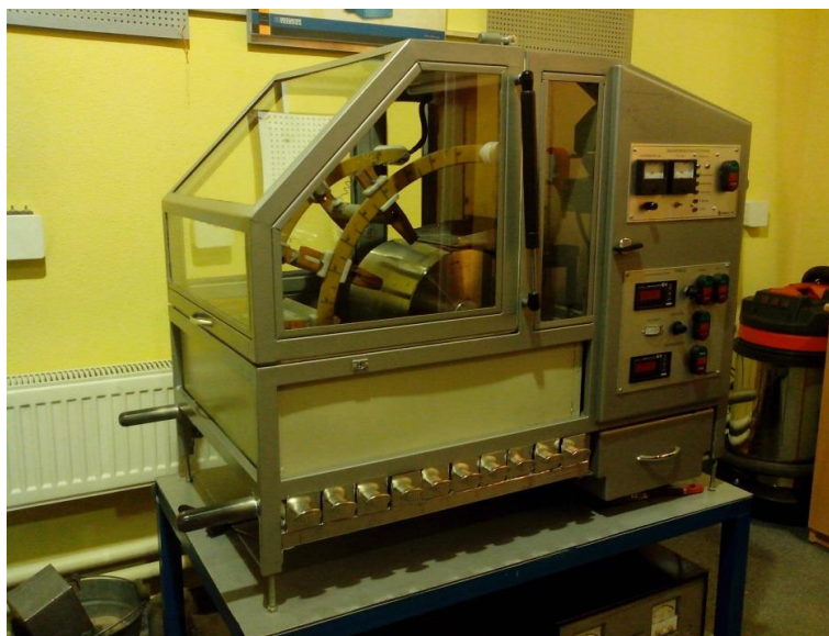
Рис. Внешний вид электростатического сепаратора ЭЛКОР-1
