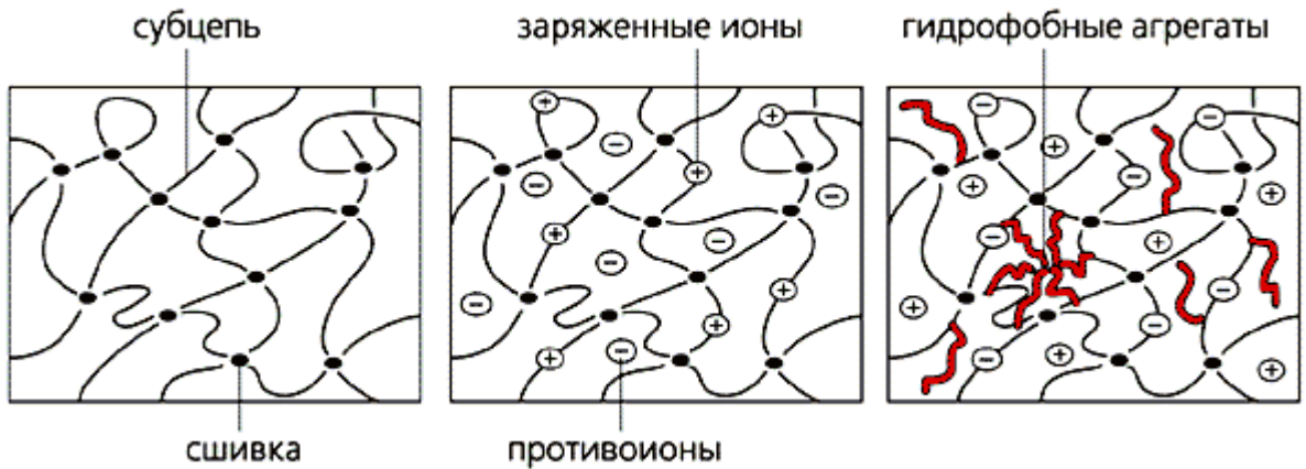
Рис. 1.3.1 - Схема строения трех форм полимерного геля
