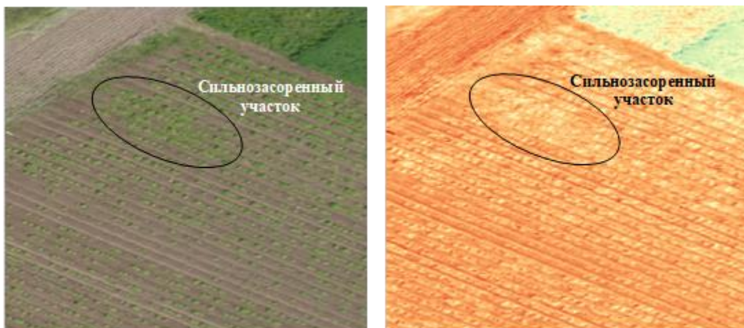
Рис. 3. Аэрофотоснимок и NDVI карта посадок картофеля в послевсходовый период при высоте культурных растений 10–15 см, созданная в программе QGIS (слева – исходный снимок в видимом диапазоне спектра, справа – NDVI карта)
