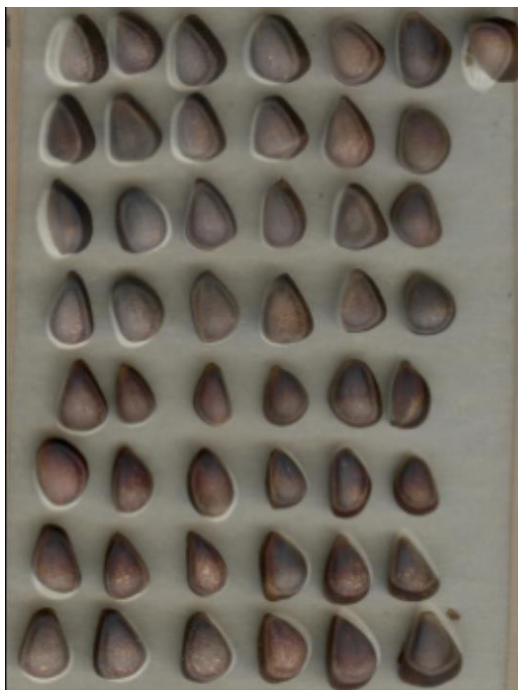
Рис. 4. Пример геометрического сферического искажения цифрового рентгеновского изображения семян Pinus nigra .
