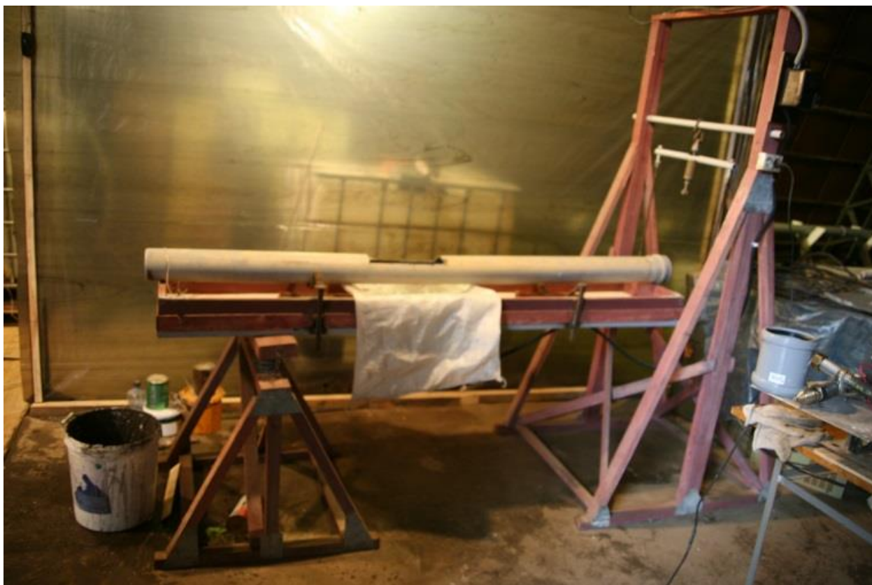
Рис. 3. Вибростол для уплотнения наилка в модельной дрене
