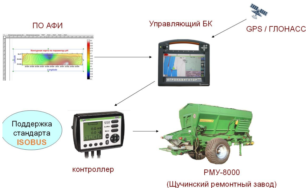
Рис. 3. Общая схема программно-аппаратного комплекса для дифференцированного внесения сыпучих удобрений и мелиорантов
