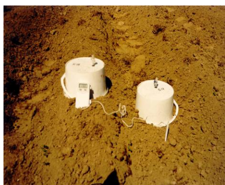
Рис. 4. Использование метода закрытых камер для измерения прямой эмиссии закиси азота и углекислого газа из почв
