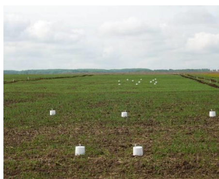
Рис. 4. Использование метода закрытых камер для измерения прямой эмиссии закиси азота и углекислого газа из почв
