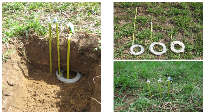
Рис. 7. Использование метода силиконовых трубок для измерения концентраций закиси азота и углекислого газа в профиле дерново-подзолистой супесчаной почвы на разной глубине
