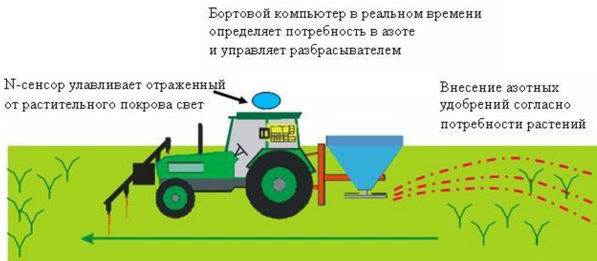
Рис 1. Схема дифференцированного внесения азотных удобрений с помощью N-сенсора
