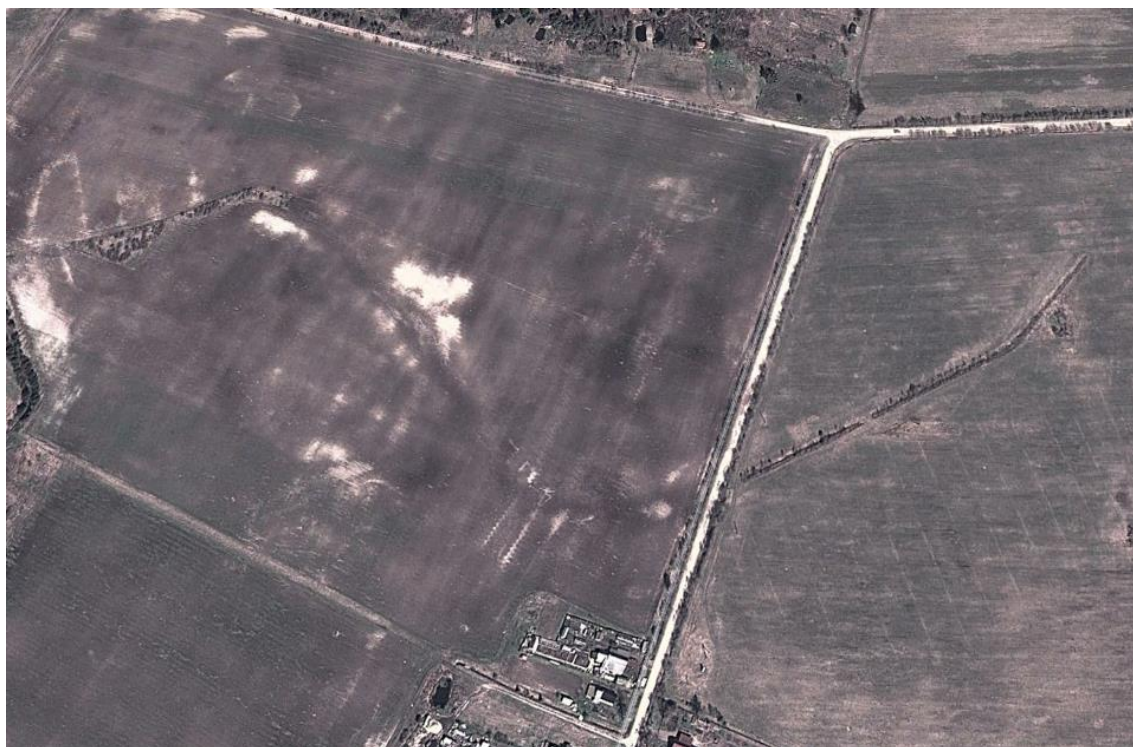
Рис. 3. Мелиоративная система с закрытыми дренами и открытыми осушительными каналами
